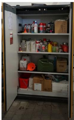
Stoffe, die eingesetzt werden, sind unter anderem Isolieröl, Maschinenöl, Reinigungsmittel, Schwefelhexafluorid, Diesel oder Benzin. Die Lagerung dieser Stoffe erfolgt in Sicherheitsschränken (siehe Bild links) und in Auffangwannen. Informationen zu den Gefahrstoffen stehen allen Mitarbeitern neben der Betriebsanweisung in einem zentralen Gefahrstoffverzeichnis zur Verfügung.
